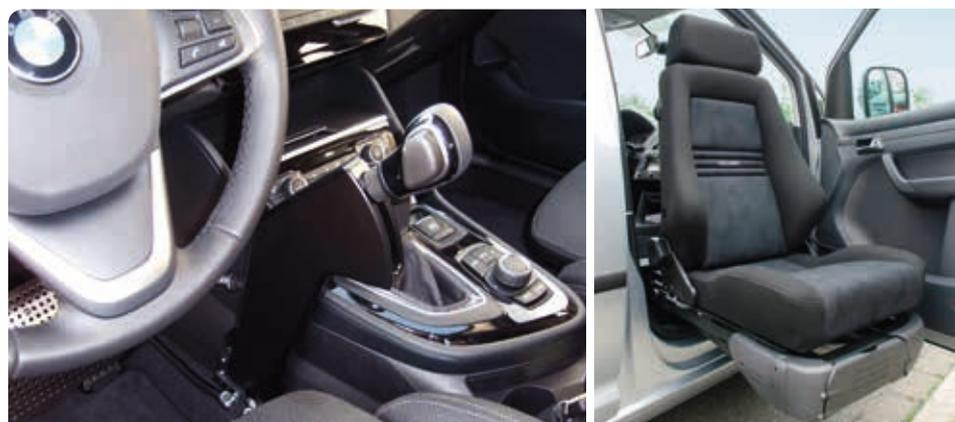
Vielfältige Unterstützung: ein Absenkfahrzeug mit Auffahrrampe (S. 38), die Bedienhilfe Easy Speed (o. l.) und der Schwenksitz Turny 1
