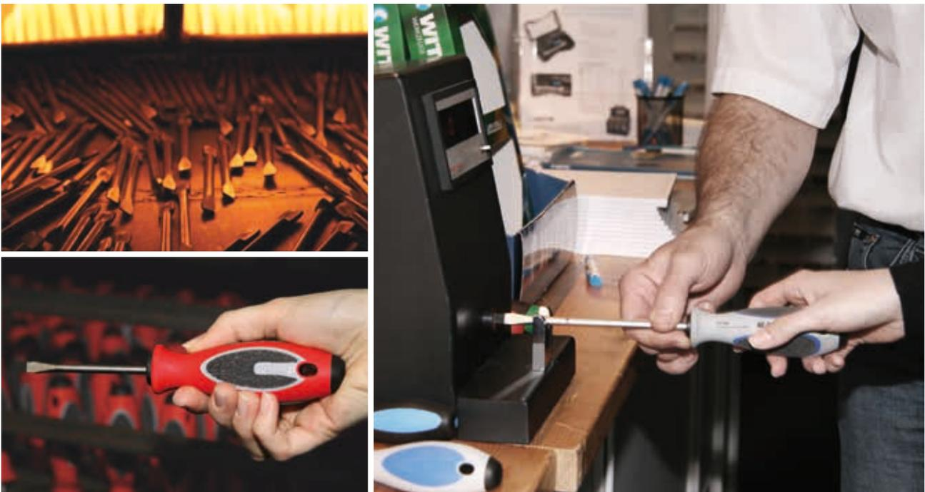
Im Ofen (o. l.) erfolgt ein Arbeitsschritt des Vergütens, das entscheidend ist für die Stabilität der Schraubendreher. Mit dem beflackten Griff am MAXXPRO (u. l.) gelangen dann auch gute Werte an der Drehmoment-Messanlage (u. r.).
