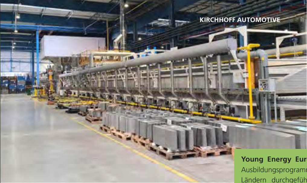
Durch Optimierungen an der Warmumformanlage konnte der jährliche Gas- und Stromverbrauch im Werk Gliwice, Polen um bis zu fünf Prozent gesenkt werden.
