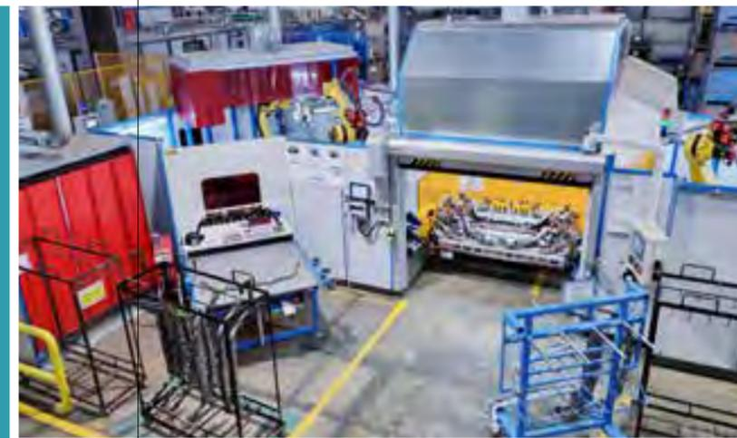
Auf einer neuen Schweißanlage fertigt KIRCHHOFF Automotive im Werk Iserlohn die Hochvolt-Spange für den BMW iX1 und den Mini Countryman electric.
