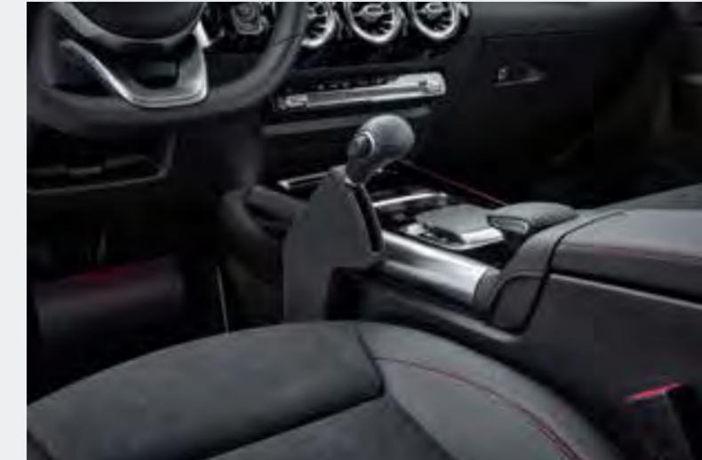
Der EasySpeed besticht durch sein ergonomisches und besonders schlankes Design. Links neben der Mittelkonsole montiert, benötigt der EasySpeed kaum Platz und sorgt gleichzeitig für maximale Beinfreiheit. Die intuitive Bedienung erfordert nur minimalen Kraftaufwand: Eine Abwärtsbewegung des Hebels beschleunigt, eine Vorwärtsbewegung bremst das Fahrzeug ab. Die Kraftübertragung erfolgt mechanisch über ein Gestänge – die Pedale bleiben voll funktionsfähig und können wie gewohnt genutzt werden.
