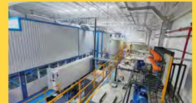
Eine durchgängige zweistufige Spülung reduziert den Wasserverbrauch auf ~4,5 m<sup>3</sup>/h. Eine Verbesserung, die unsere Nachhaltigkeitsziele unterstützt, indem der Wasserbedarf gesenkt und gleichzeitig die Prozesseffizienz gewährleistet wird.
