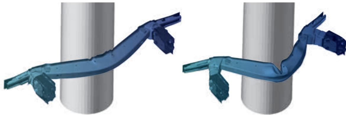
Schutz der Batterie durch biegesteife oder biegeweiche Crashmanagement-Systeme für größtmögliche Verzögerung beim Crash. Welche Variante zum Einsatz kommt, hängt vom Lastpfadkonzept, also der Gestaltung der Rohkarosserie-Struktur hinsichtlich passiver Sicherheit, ab.
