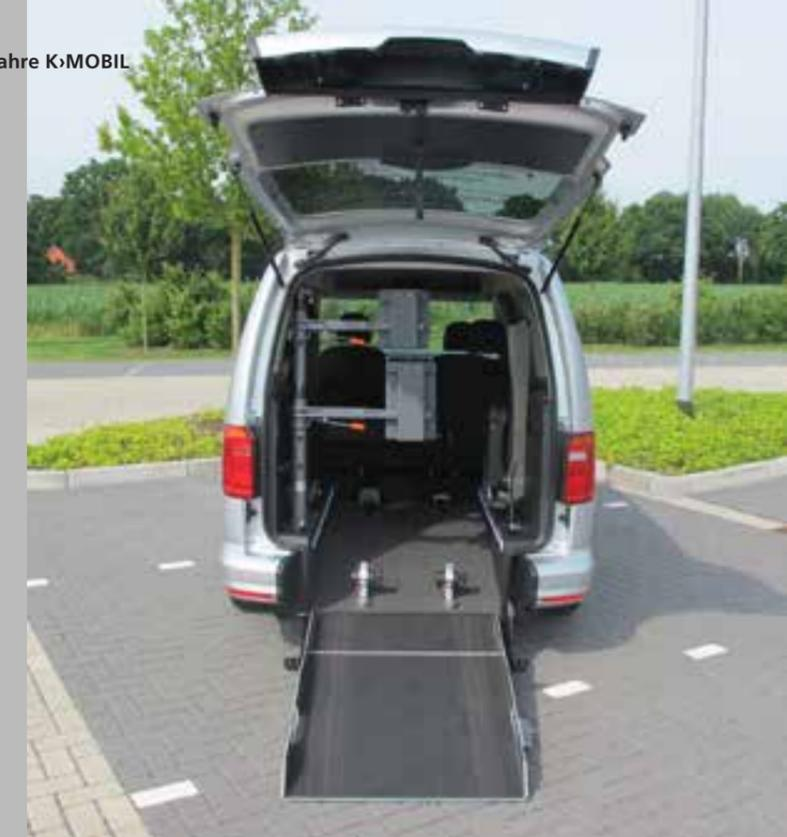
Eines der Kernprodukte von KIRCHHOFF Mobility: Der Heckausschnitt NIVO, hier im VW Caddy. Auf diesem Bausatz basieren behindertengerechte Umbauten für diverse Hochdachkombi Modelle.
