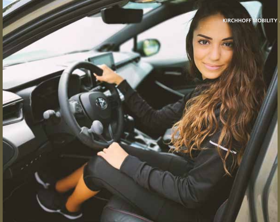
Abassia in ihrem Toyota Corolla Hybrid mit Handbediengerät Carospeed für Gas und Bremse, Lenkraddrehknopf Ergo und Pedalabdeckung
