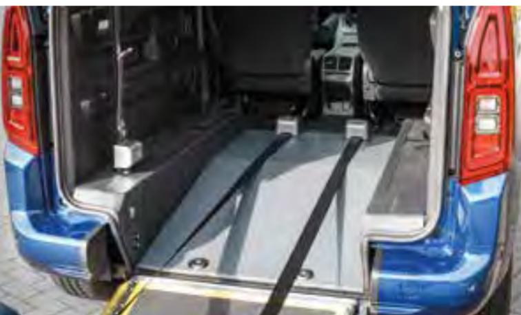
Der breite Bodenausschnitt und die rutschsichere Rampe des NIVO ermöglichen dem Rollstuhlfahrer einen bequemen und einfachen Ein- und Ausstieg.
