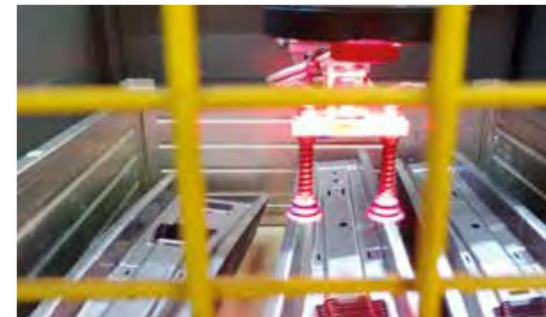
Automatische Entnahme von Bauteilen und Zuführung zu den Fügeprozessen
