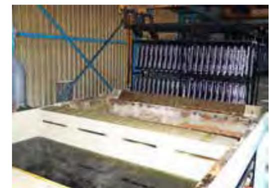
Das Beizbecken wurde mit säurebeständigem PP-Kunststoff ausgekleidet. Lüftungsschlitze saugen die hier entstehenden Dämpfe ab.
