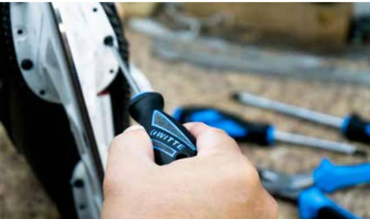
In der Roosters Werkstatt: Bei einem Schlittschuh wird der Kufenhalter, der sogenannte Holder, mit Profiwerkzeug für Profi-Eishockey-Equipment befestigt.
