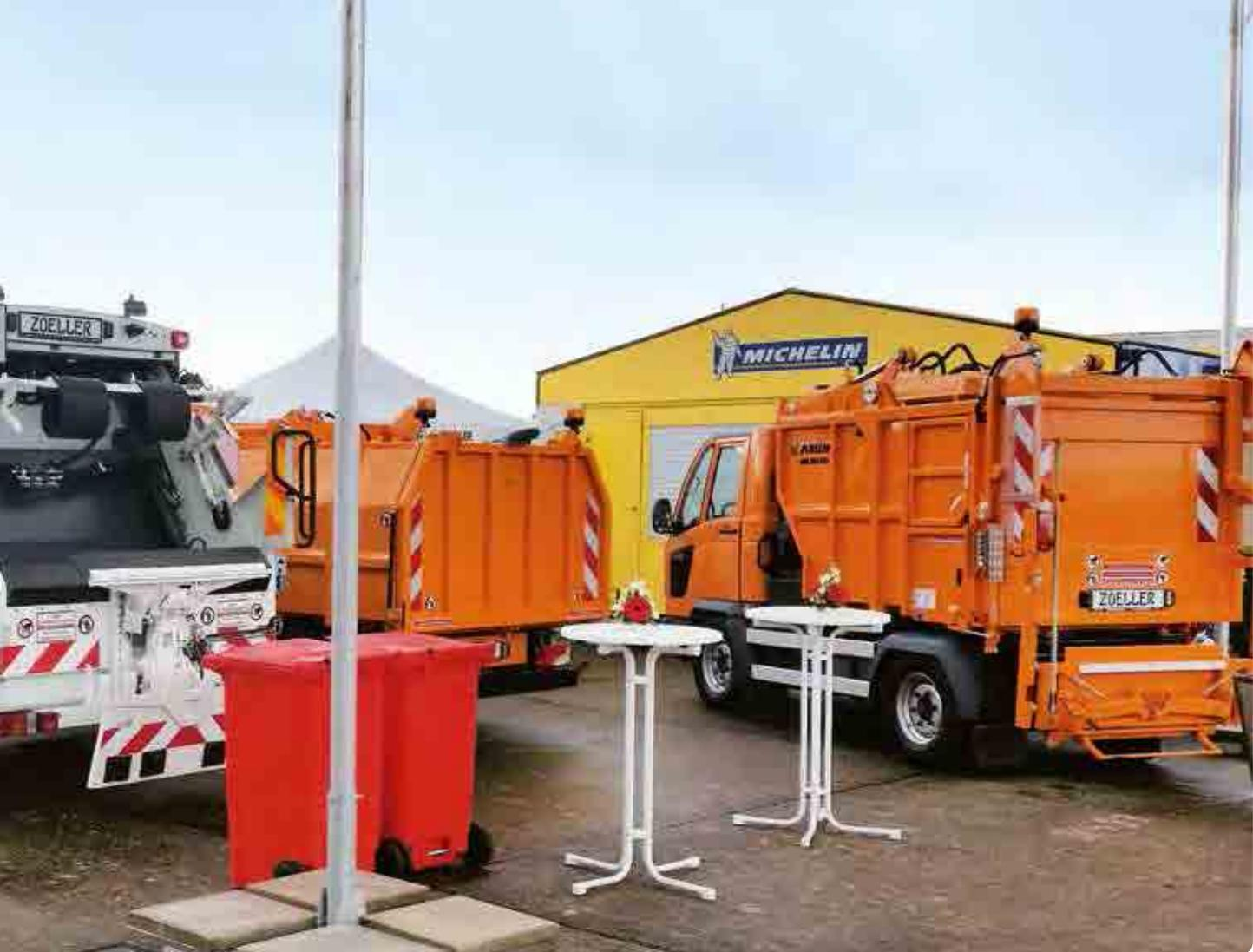
**Oben:** Die Kleinsten – Abfallsammelfahrzeuge der Reihe MICRO auf dem ZOELLER-Messestand: MICRO XL mit E-Power System, MICRO HG HK, MICRO HG mit Lifter SL 240. **Unten:** Klein, wendig, vielseitig – der MICRO XL mit E-Power System.
