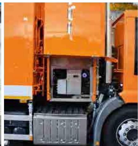
**Links:** Das sogenannte Waterpack ist zwischen Aufbau und Kabine montiert. Größte Wendigkeit ist durch kurze Radstände ab 3.600 mm + 1.350 mm möglich. **Rechts:** Alle wichtigen Bauteile sind durch Aufklappen der Wartungstüre leicht zugänglich. Eine Heißwasseranlage ist jederzeit problemlos nachrüstbar.
