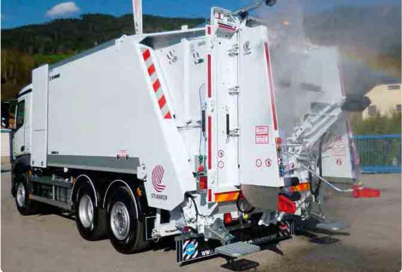
**Links:** ZOELLER ROTARY Automatiklifter und 800 Liter Stahlbehälter in Waschposition: Auch in der Schweiz schätzt man die Reinigungsleistung des STUMMER Waschbären. Die Wascheinrichtung kann wahlweise in Verbindung mit Automatik- oder manuellen Liftersystemen kombiniert werden. **Rechts:** Die schwenkbaren Roboterarme mit den Waschköpfen sorgen für perfekte Reinigung der Müllbehälter. Pro Behälter benötigt man ca. drei Liter Wasser, bei einem Wasserdruck von 120 bar.
