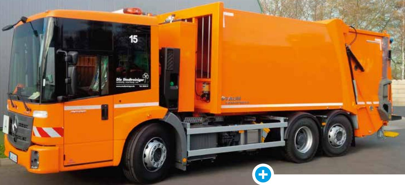
Das Batteriepaket E-POWER sitzt zwischen Fahrerhaus und Aufbaubehälter VARIOPRESS.
