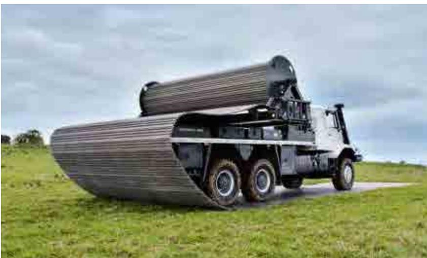
**Oben:** Mit HGMS-IV können 30 Meter mobile Fahrbahn ausgelegt werden. **Links:** HGMS-IV ist eine speziell entwickelte Hybrid-Variante des bekannten HGMS, das über eine eigene Stromversorgung verfügt.
