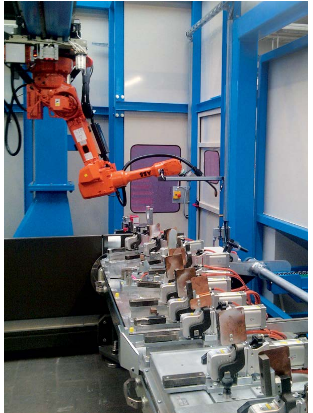
Links: Ausschweißen der Längsnähte Rechts: Einschweißen von Stegblechen und Verstärkungen in die Halbschale
