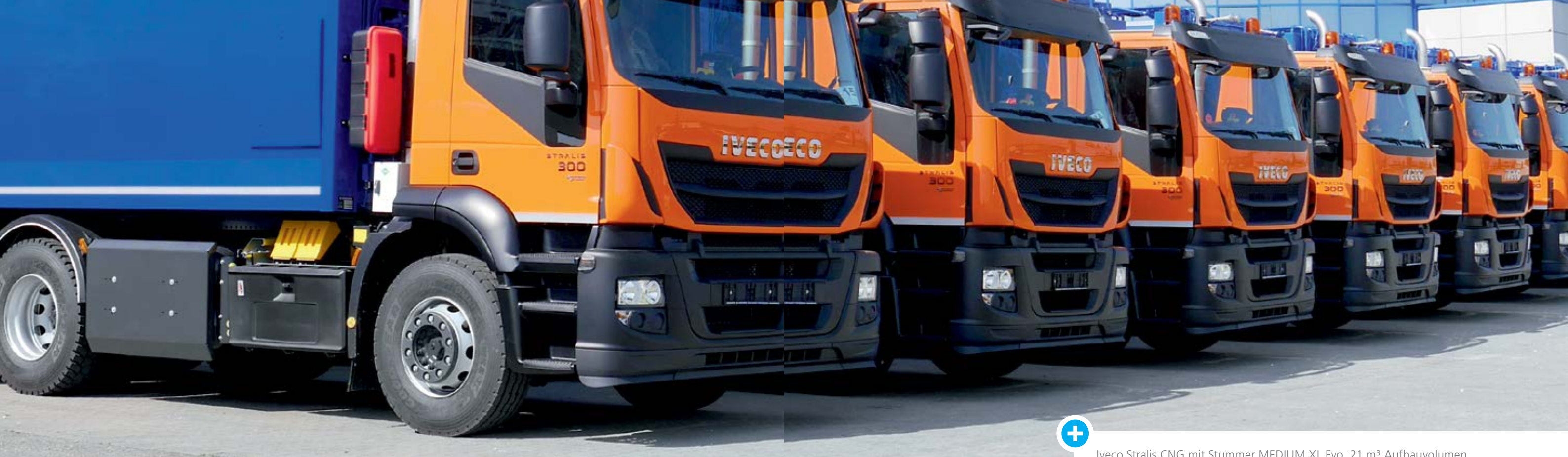
Iveco Stralis CNG mit Stummer MEDIUM XL Evo, 21 m 3 Aufbauvolumen
