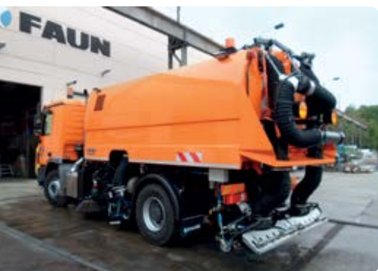
Größere Saug- und Blasschläuche und eine Hecksauganlage für mehr Power
