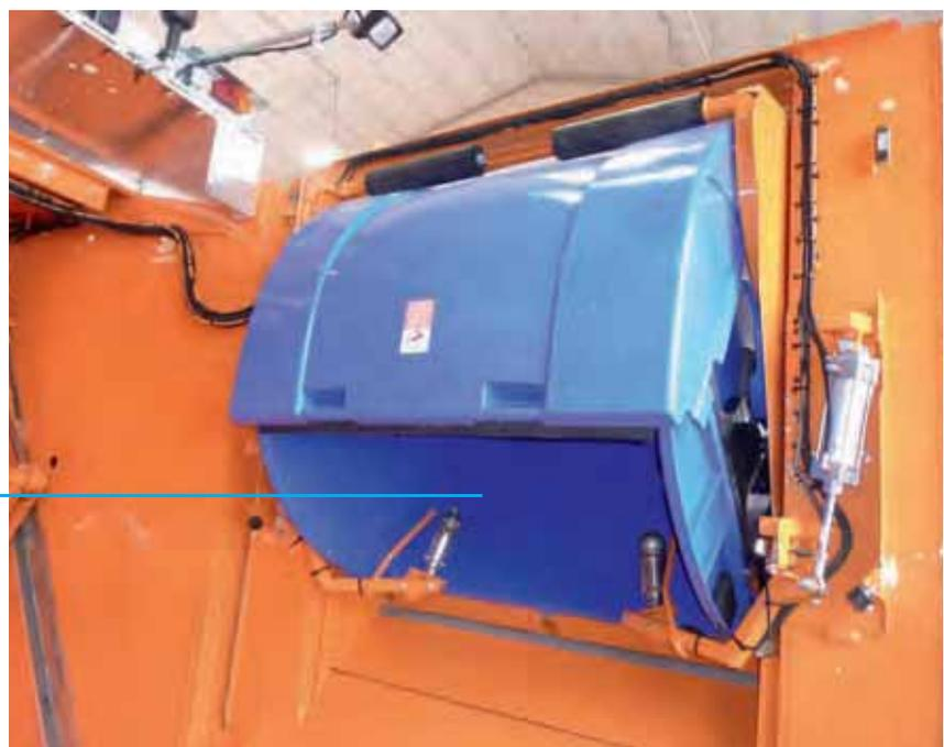
*MEDIUM XLS WASCHKOMBI mit Blick ins Heckteil / Schwenktür mit Waschdüsen auf Roboterarmen*
