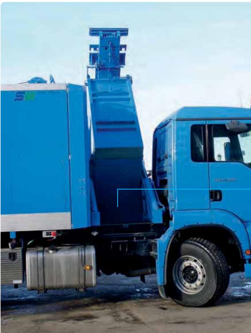
Bio- oder Glasbox in Kippstellung, zur seitlichen Entleerung. Die Biobox ist auch in Edelstahlausführung erhältlich.
