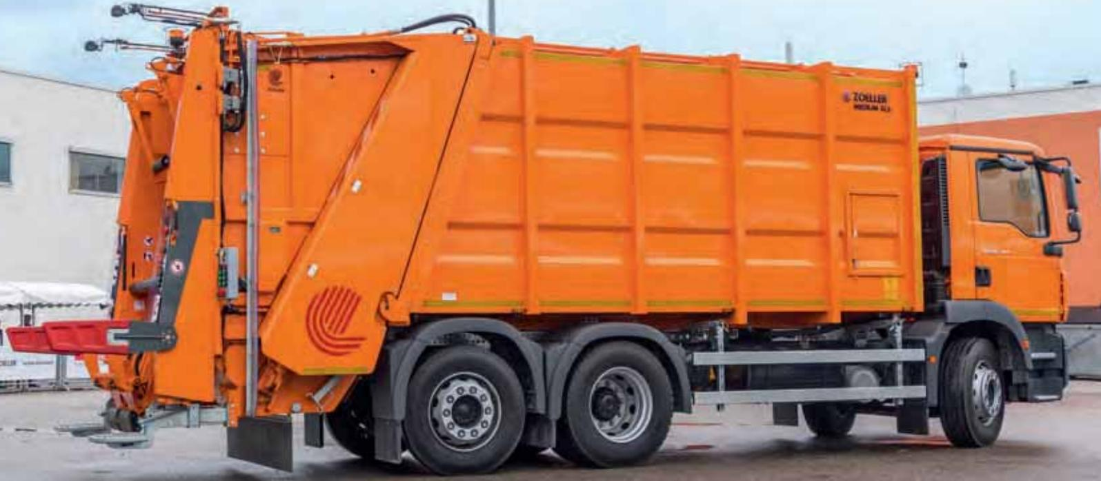
MEDIUM XLS mit integriertem Lifter ZOELLER-ROTARY III, Low-Level mit Klapprutsche
