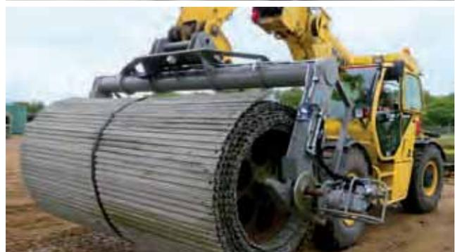
**Links:** MGMS-BD erlaubt mit seinem Schwenkkopf Bewegungen von 180 Grad, so dass auch schmale Bereiche erreicht werden können. **Oben:** MGMS-BD LITE ist ein statisches, kostengünstigeres System für Anwender, die weniger Flexibilität benötigen. **Unten:** MGMS-BD kann TRACKWAY-Matten der Klassen MLC 30 auslegen.
