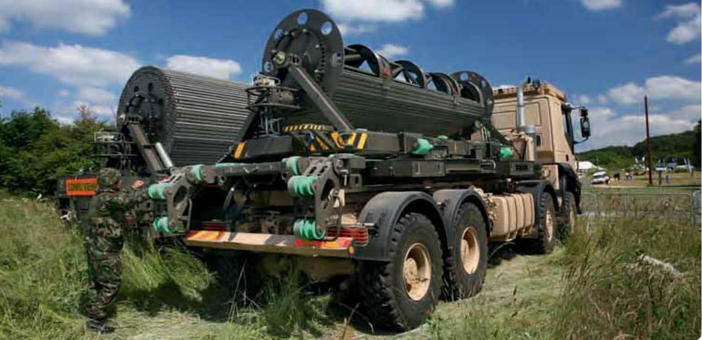
Das HGMS-System von TRACKWAY ist bestens für mobile Einsätze geeignet.
