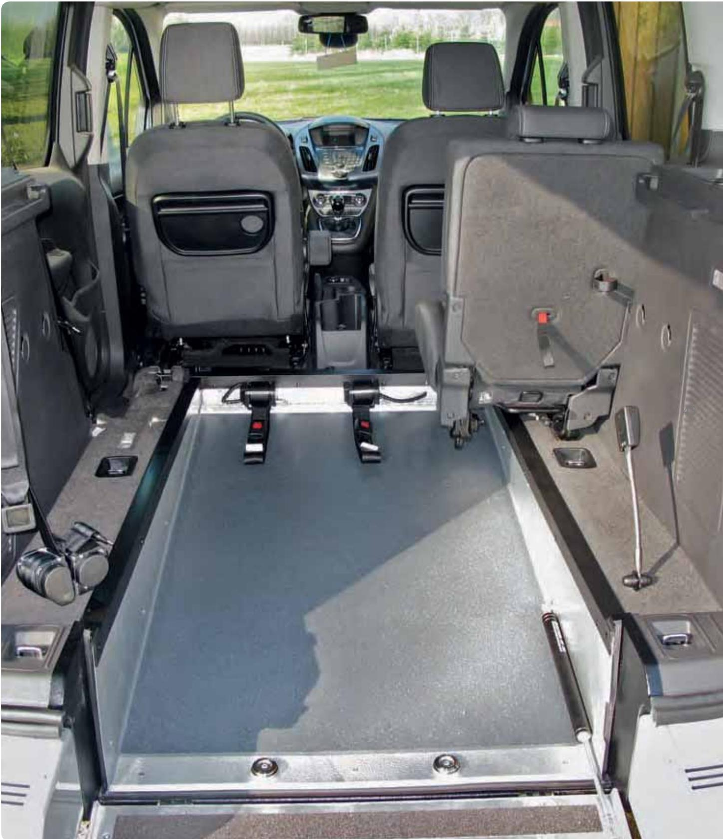
Im Vergleich zu anderen umgebauten Fahrzeugen macht die beeindruckende Laderaumlänge gerade den Grand Tourneo Connect zu einem für Rollstuhlfahrer sehr geeigneten Automobil. Mit wenigen Handgriffen lässt sich die flexible zweite Sitzreihe kinderleicht zu einem 3-Sitzer plus Rollstuhlfahrerplatz umbauen.
