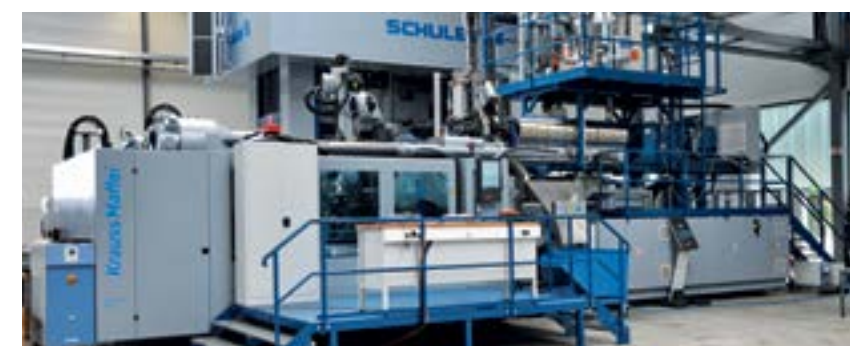
Spritzgießcompounder mit einer Schließkraft von 13.000 kN
