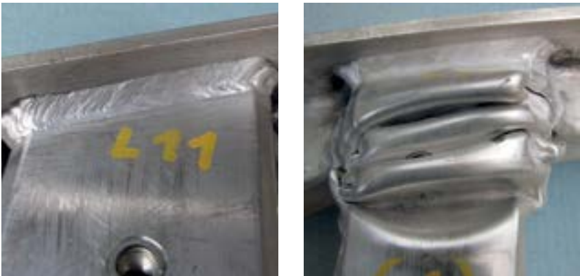
Abb. 4: Schweißverbindung Crashbox/Stoßfänger vor und nach dem Fallturmversuch
