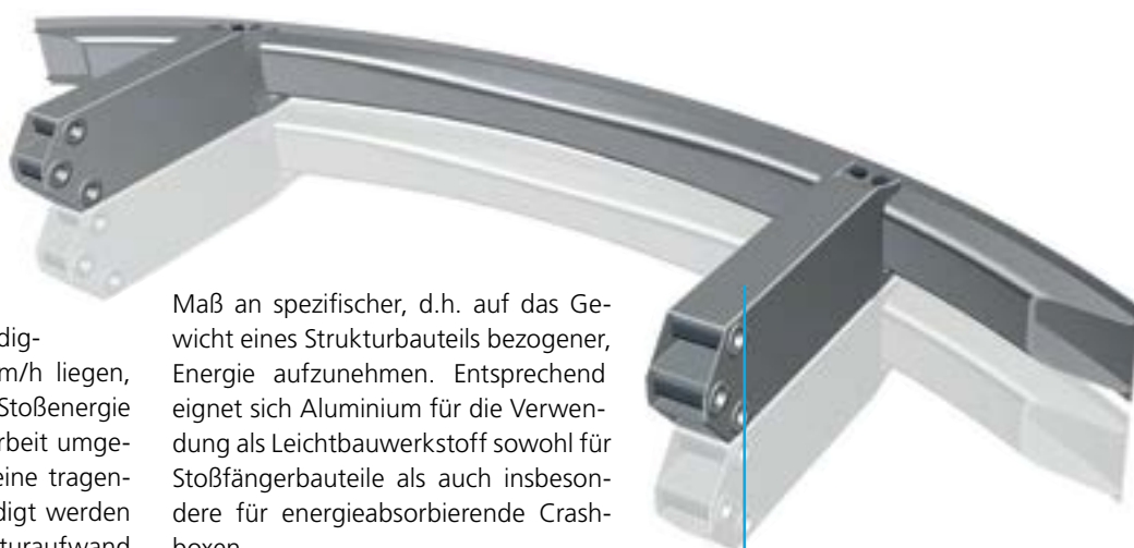
Abb.1: Crash Management Sys- tem mit verschraubten Crash- boxen
