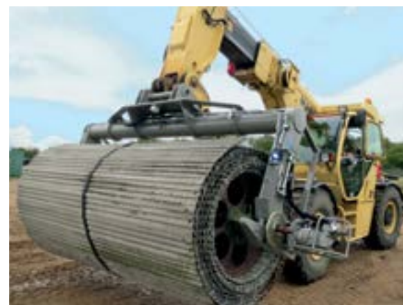
Verteilersystem MGMS-BD für das Ausrollen mobiler Straßen auf unwegsamem Untergrund für Leichtfahrzeuge
